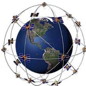
Несмотря на то, что для нормальной работы системы достаточно 24-х спутников, на данный момент в орбитальную группировку входит 30 рабочих аппаратов. Это помогает добиться более точного определения координат.
